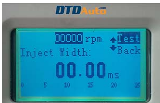
Màn hình tạo xung và kiểm tra kim phun
